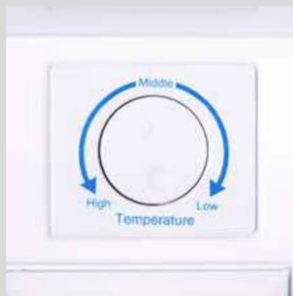
Termostato en el interior del minibar
